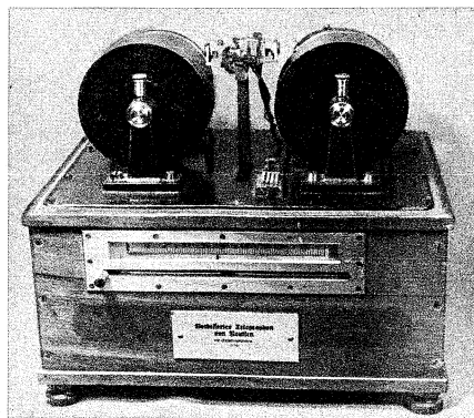
Bild 4. Verbessertes Poulsen-Telegraphon für Schnelltelegrafieempfang mit zwei Spulen für Stahldrahtstreifen (1904)
