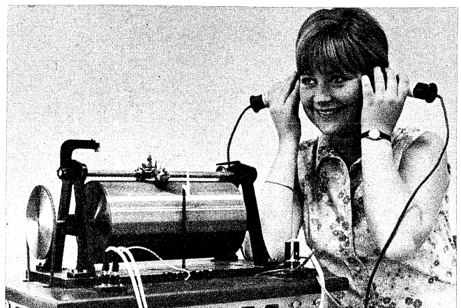
Bild 3. Poulsens erstes Telegraphon (1898) mit einer Drahtgeschwindigkeit von 2 m/s (DRP 109 569)
