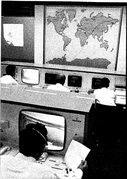
Bild 3. Blick in das Deutsche Satelliten-Kontrollzentrum Oberpfaffenhofen, scherzhaft auch „Klein-Houston“ genannt. Im Hintergrund die Weltkarte in Mercator-Projektion, auf der mit Hilfe eines neuartigen Gas-Lasergerätes die Satellitenumlaufbahn sichtbar gemacht wird
